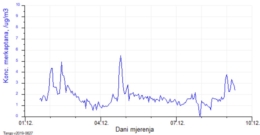
Slika 4.2.4: Grafički prikaz usrednjenih imisijskih 60 – minutnih koncentracija merkaptana na lokaciji južno od UPOV Belišće za razdoblje mjerenja 1.12.- 9.12.2021.
